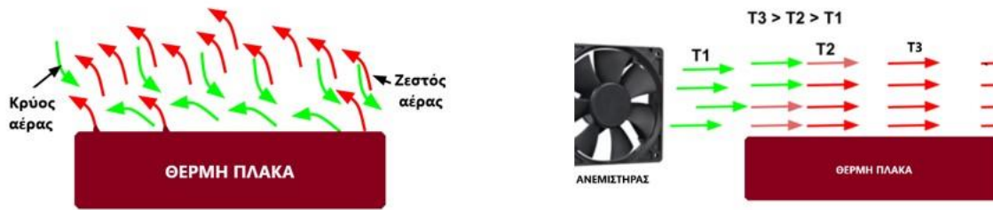
Σχήμα 2- 5: Μηχανισμός συναγωγής γύρω από θερμή πλάκα, Αριστερά: φυσική συναγωγή, Δεξιά: εξαναγκασμένη συναγωγή. [9]
