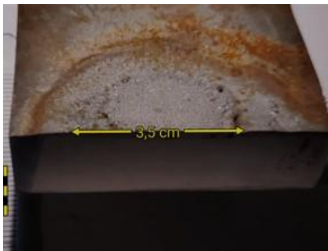
Σχήμα 6- 3: Μακροσκοπική όψη μετά την κοπή του κατεργασμένου δοκιμίου.
