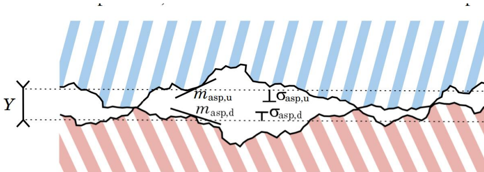
Σχήμα 4- 10: Οι αποκλίσεις των συνδεόμενων επιφανειών σε πραγματικές επιφάνειες [13].
