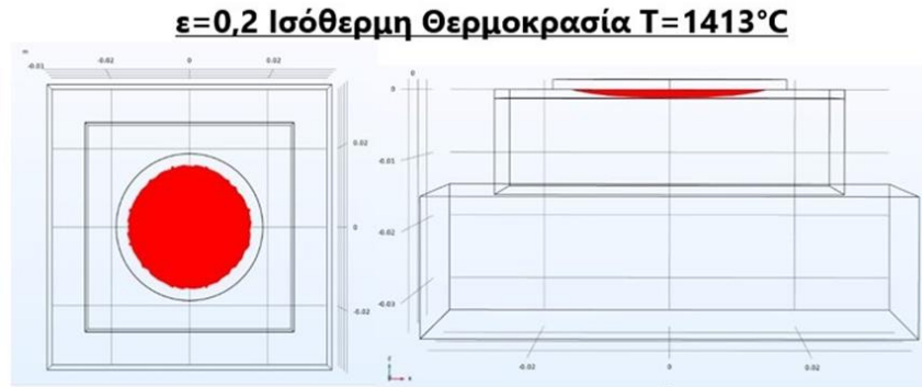
Σχήμα 5- 9: Ισόθερμη θερμοκρασία σε βάθος (z=-0.0013m) για ε=0,2
