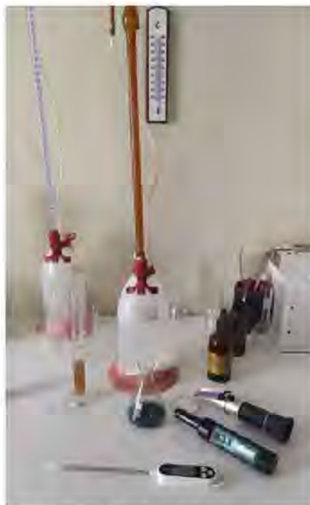
Εικόνα 13. Όργανα για τον προσδιορισμό της ολικής οξύτητας και των σακχάρων του γλεύκους.
