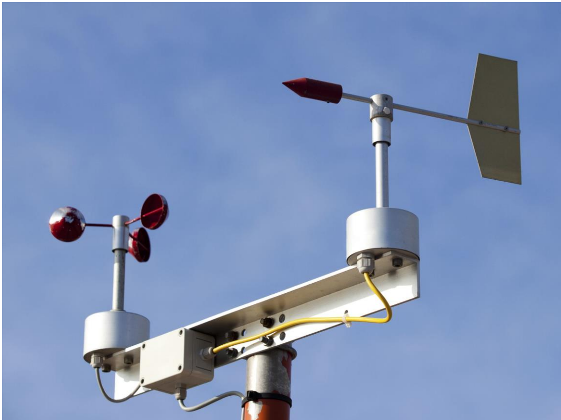
Εικόνα 5.4: Αριστερά ανεμόμετρο, δεξιά ανεμοδείκτης. [31]
