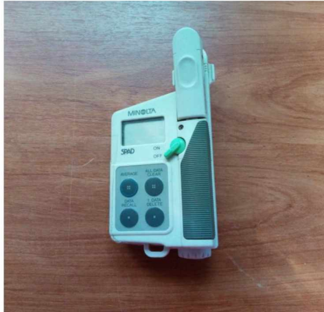
Εικόνα 9. Όργανο μέτρησης της σχετικής συγκέντρωσης χλωροφύλλης (προσωπικό αρχείο, 2020).
