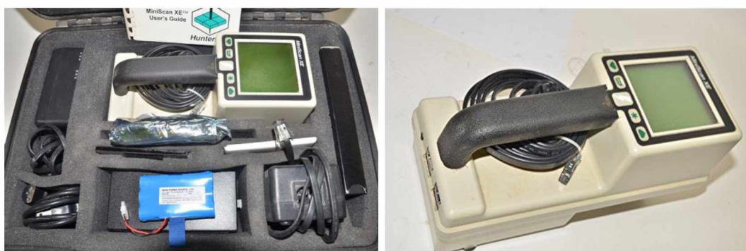
Εικόνες 32,33. Όργανο μέτρησης του χρώματος των καρπών φράουλας (προσωπικό αρχείο, 2020).
