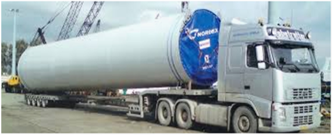
Εικόνα 4.5: Μεταφορά Πύργου Ανεμογεννήτριας
