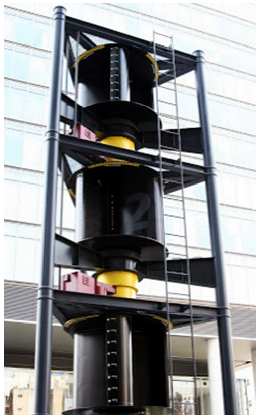
Εικόνα 3.3: Σύστημα με πολλαπλές Ανεμογεννήτριες τύπου Savonius (Καλδέλης, 2005).
