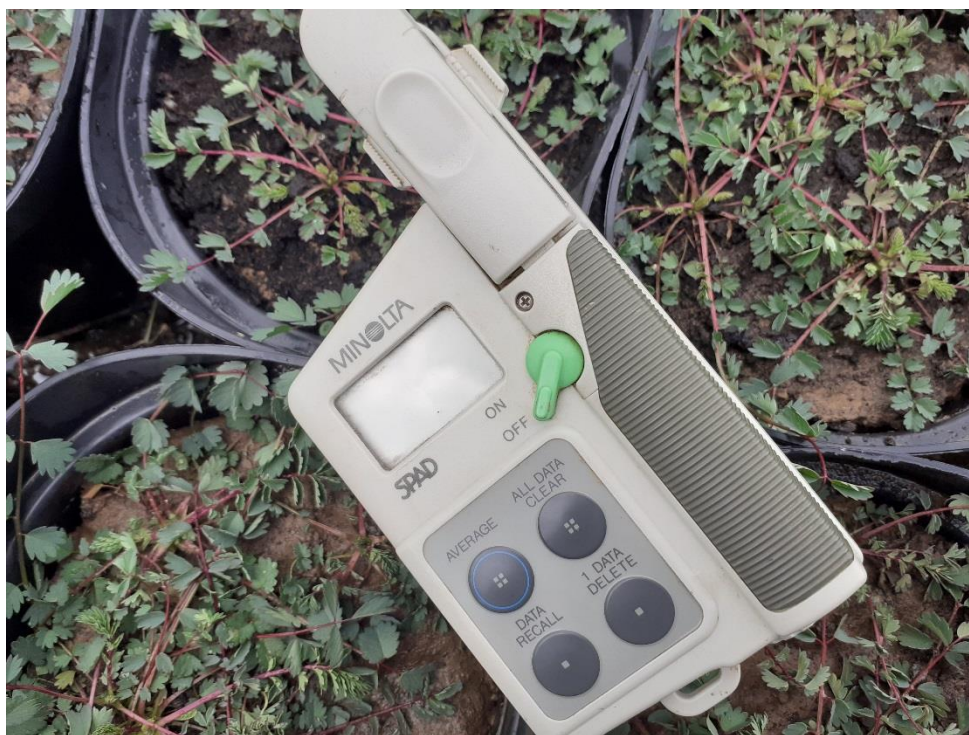
Εικόνα 2.5. Φορητό όργανο μέτρησης (SPAD- chlorophyll meter) της σχετικής συγκέντρωσης της χλωροφύλλης στα σύνθετα φύλλα του είδους S. minor .
