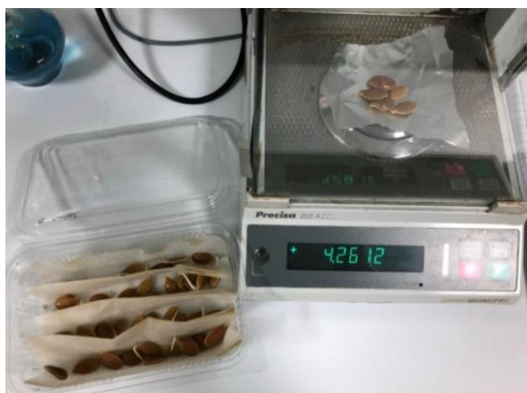
Εικόνα 2.2. Ζυγός ακριβείας για τη ζύγιση σπόρων κολοκύθας με σκοπό τον υπολογισμό του ποσοστού απορρόφησης H 2 O των σπόρων
