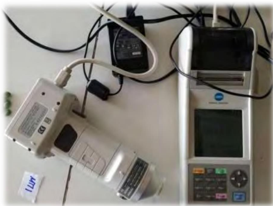
Εικόνα 3. Χρωματόμετρο Minolta που χρησιμοποιήθηκε για τη μέτρηση του χρώματος του φλοιού των καρπών.
