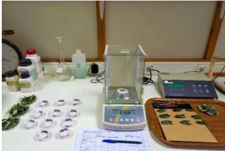
Εικόνα 3. Μέτρηση του νεπού βάρους των δίσκων ελάσματος των φύλλων με ζυγό ακριβείας 4 δεκαδικών ψηφίων (Kern)
