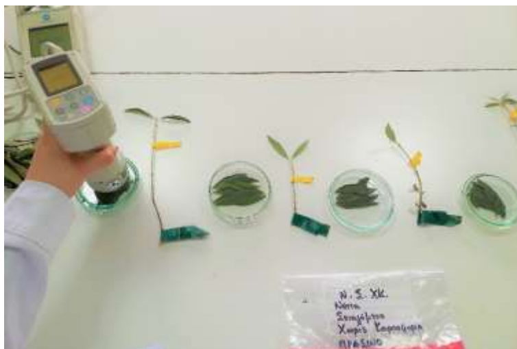
Εικόνα 2.. Μέτρηση του χρώματος των φύλλων με το χρωματόμετρο Minolta.
