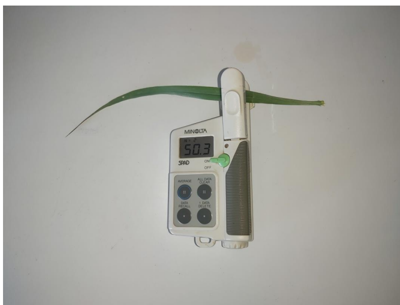
Εικόνα 6. Όργανο καταγραφής χλωροφύλλης – SPAD.
