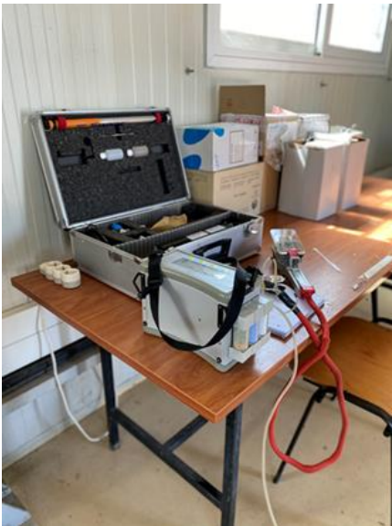
Εικόνα 4 Όργανο μέτρησης φωτοσύνθεσης (LCpro, ADC Bioscientific Ltd., UK)
