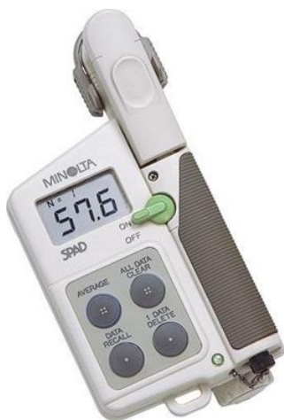
Εικόνα 5 Όργανο μέτρησης χλωροφύλλης(Chlorophyll Meter SPAD-502 Plus, Konica Minolta Europe)
