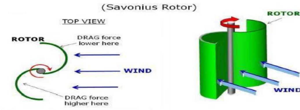
Εικόνα 5.5.2.3: Ανεμογεννήτρια Καθέτου Άξονα με Ρότορα Savonius (Πηγή: Nandi, 2014).
