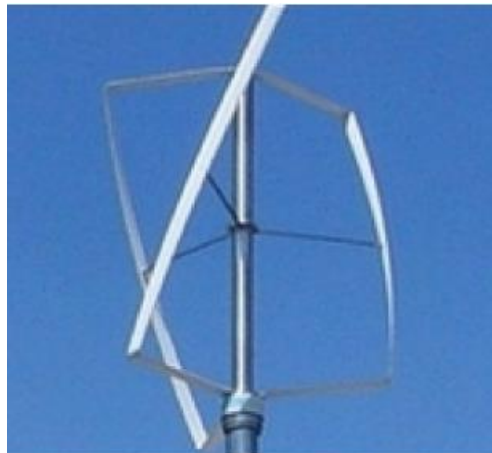
Εικόνα 5.5.2.2: Ανεμογεννήτρια Καθέτου Άξονα Darrieus (Πηγή: Ayhan & Sağlam, 2012).
