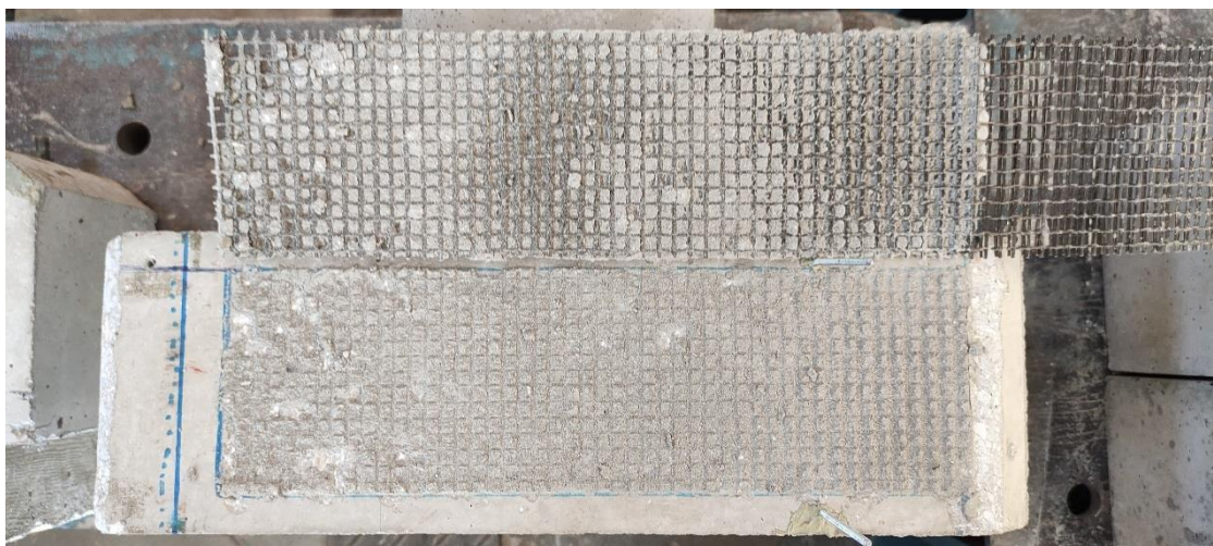
Σχήμα 4.2.3.2: Διαστρωματική αποκόλληση στη διεπιφάνεια πλέγματος- κονιάματος ως μορφή αστοχίας του δοκιμίου CM_2B_300-2.
