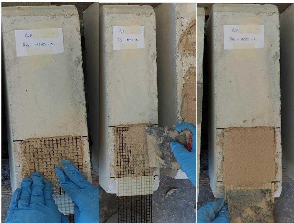
3.5.2.1: Διαδικασία εφαρμογής IAM με μήτρα γεωπολυμερούς.
