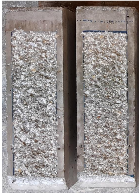
Σχήμα 3.5.1.1: Εκτραχυμένη επιφάνεια πρισματικού δοκιμίου.
