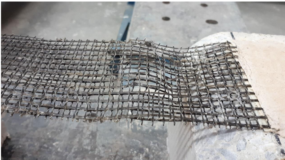
Σχήμα 4.2.2.2: Θραύση ινών βασάλτη ως μορφή αστοχίας του δοκιμίου GP_2B_50-2.
