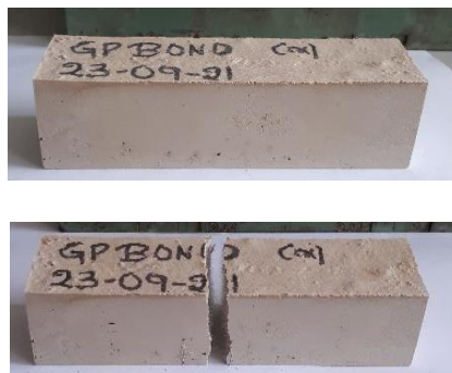
Σχήμα 3.3.3.2: Δοκίμιο κονιάματος γεωπολυμερούς πριν και μετά τη δοκιμή κάμψης τριών σημείων.
