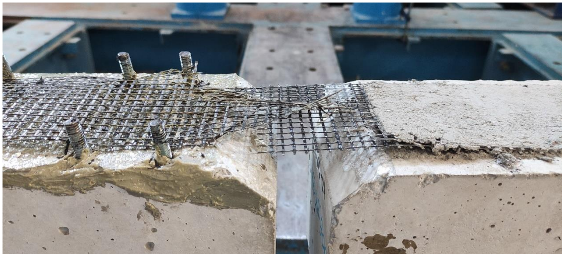
Σχήμα 4.2.3.1: Θραύση ινών βασάλτη ως μορφή αστοχίας του δοκιμίου CM_2B_300-1.
