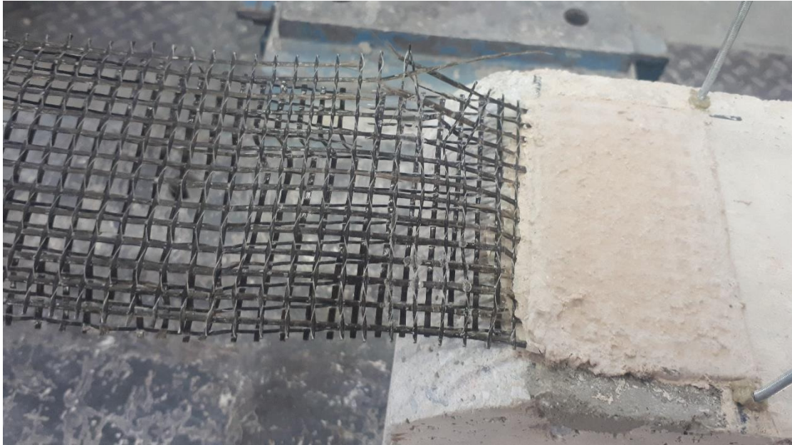
Σχήμα 4.2.2.1: Θραύση ινών βασάλτη ως μορφή αστοχίας του δοκιμίου GP_2B_50-1.
