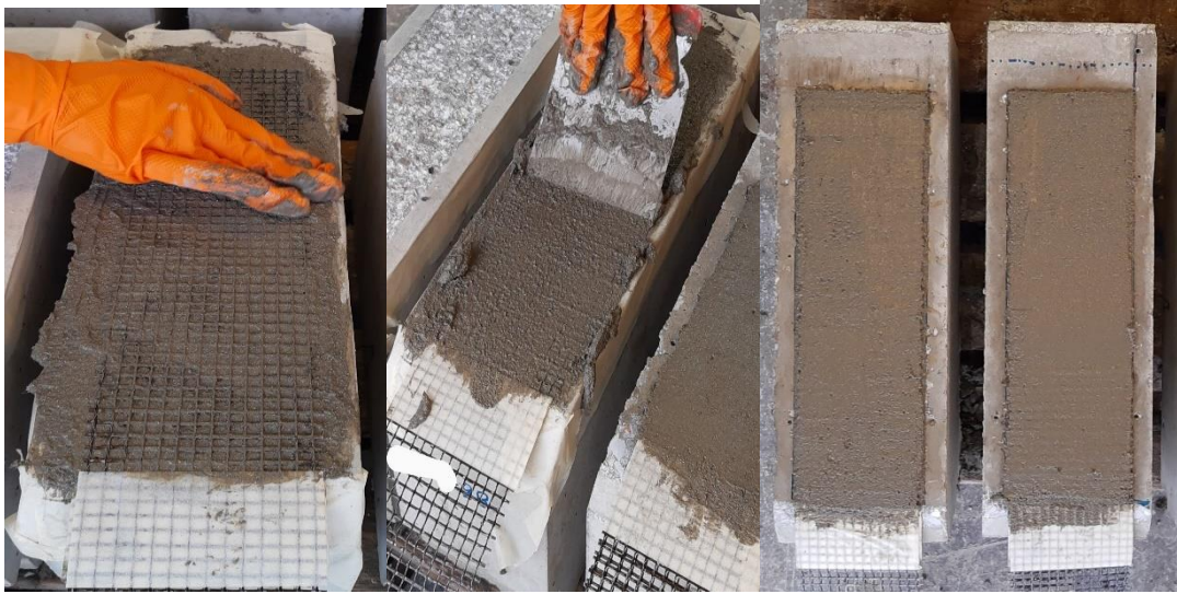
Σχήμα 3.5.2.2: Διαδικασία εφαρμογής IAM με τσιμεντοειδή μήτρα.
