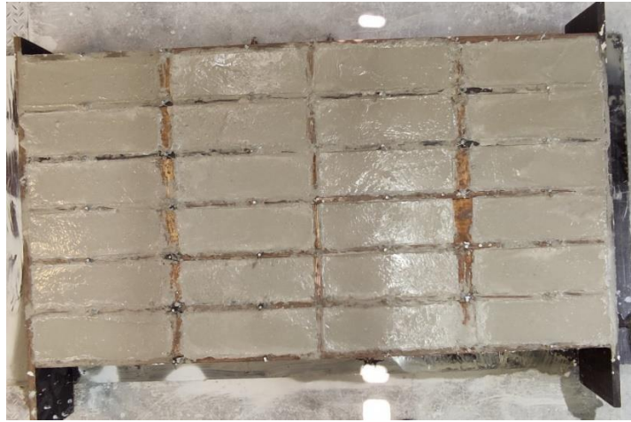
Σχήμα 3.3.1.1: Τελική μορφή του νωπού σκυροδέματος στα καλούπια.
