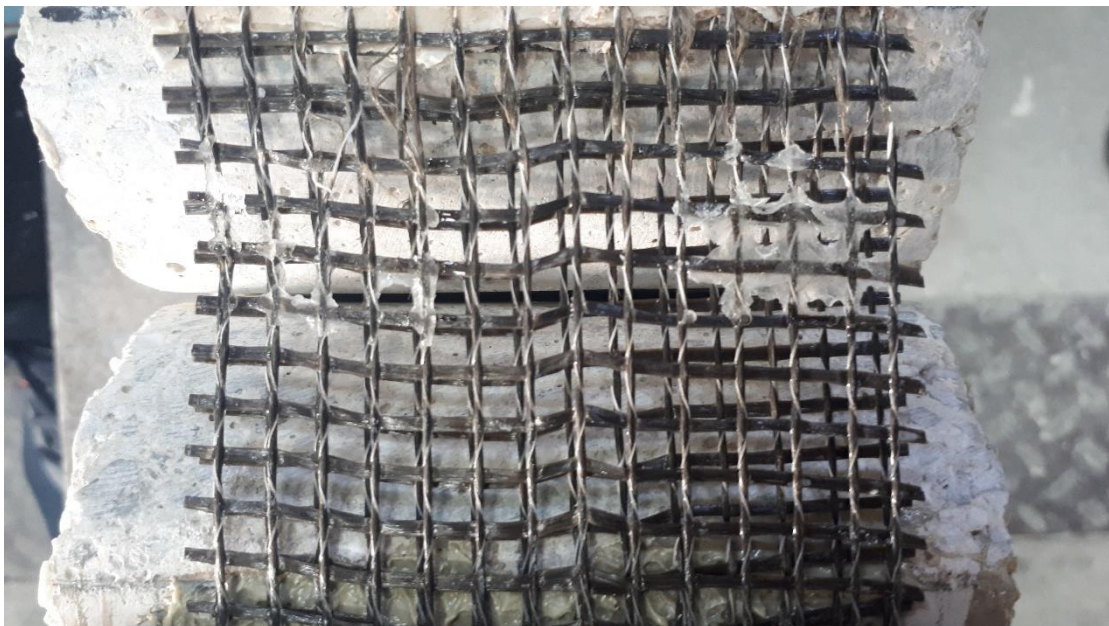
Σχήμα 4.2.1.2: Θραύση ινών βασάλτη ως μορφή αστοχίας του δοκίμιου GP_2B_300-1.
