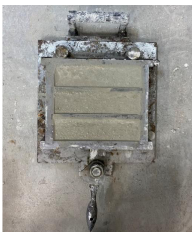
Σχήμα 3.4: Εφαρμογή κονιάματος στη μεταλλική μήτρα
