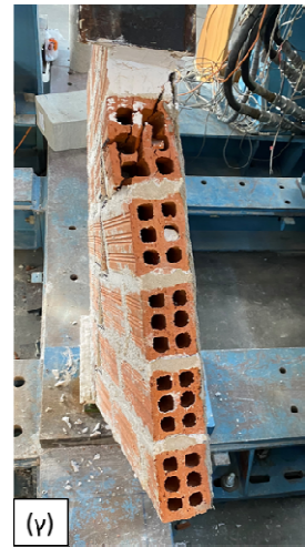
Σχήμα 4.11: Τυπική μορφή αστοχίας δοκίμιου με ενίσχυση υάλου (α) Ενισχυμένη πλευρά δοκίμιου G2_2 (β) Μη ενισχυμένη πλευρά δοκίμιου G2_3 (γ) Πλάγια όψη δοκίμιου G2_1
