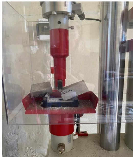
Σχήμα 3.9: Αστοχία δοκιμίου σε πείραμα κάμψης τριών σημείων.
