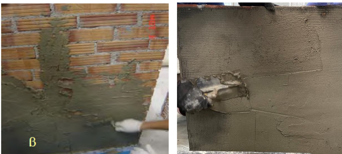
Σχήμα 2.2: Πειραματική εφαρμογή ενίσχυσης τοιχοποιίας
