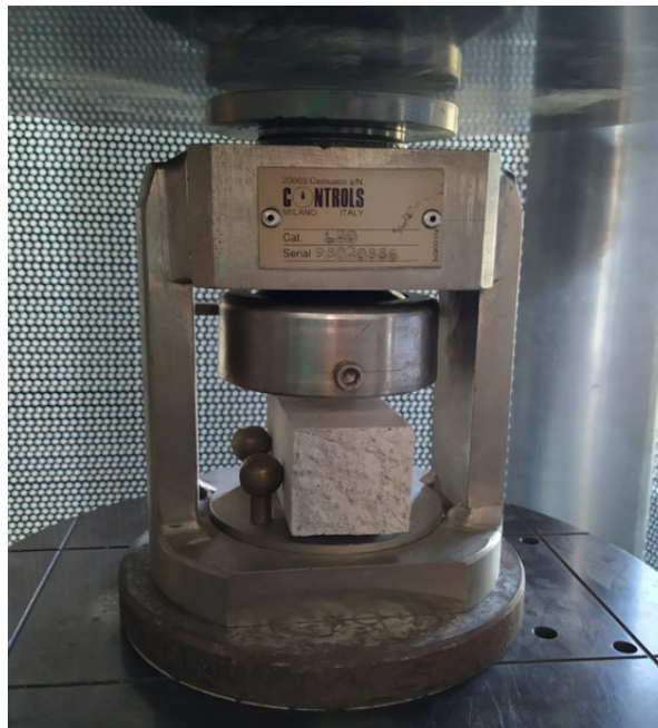
Σχήμα 3.6: Πείραμα θλίψης δείγματος κονιάματος
