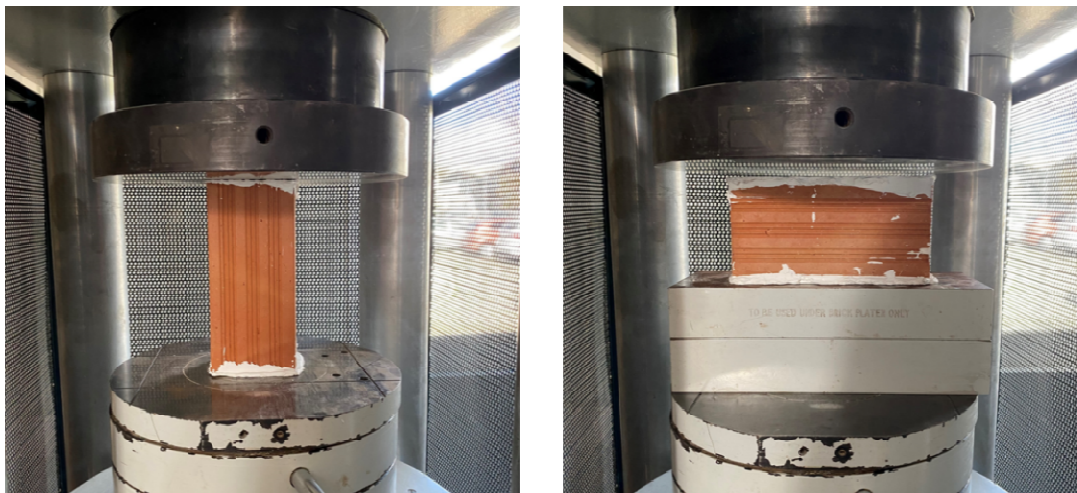
Σχήμα 3.2: Δοκιμή μονοαξονικής θλίψης μεμονωμένων οπτόπλινθων.
