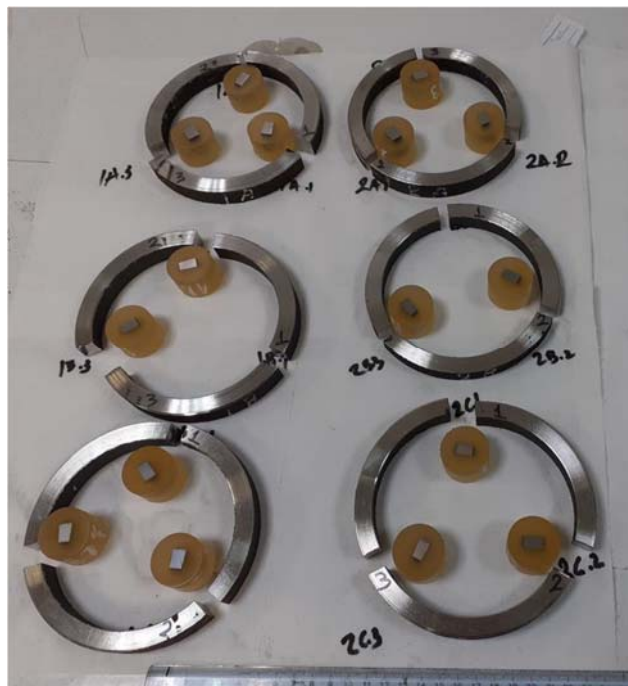
Σχήμα 3.4: Τα μεταλλογραφικά δοκίμια που κόπηκαν από τους 2 αυλούς.
