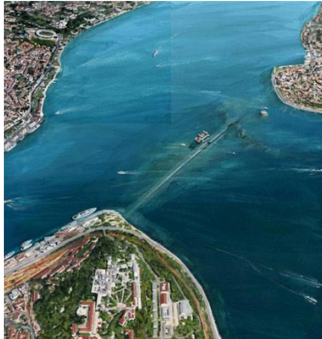
Εικόνα 3. 16 Φωτογραφία από την ευθυγράμμιση της Υποθαλάσσιας Σήραγγας στο Βόσπορο.
