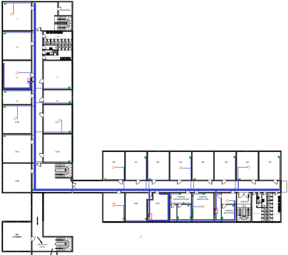
Εικόνα 6: Γενική Κάτοψη Δομημένης Καλωδίωσης
