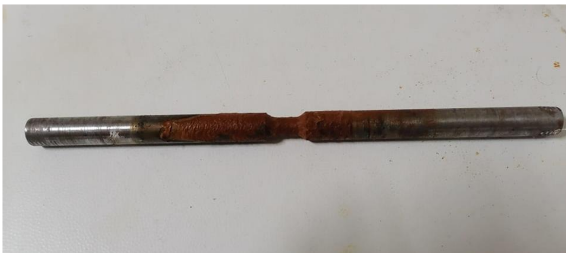
Εικόνα 4.13 (Δοκίμιο αναφοράς έπειτα από 167 ώρες σε συνθήκες κόπωσης με διάβρωση)
