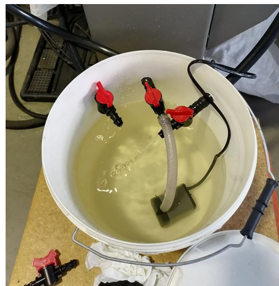
Εικόνα 4.10 (Δοχείο διαλύματος με συνδεδεμένη την αντλία νερού)
