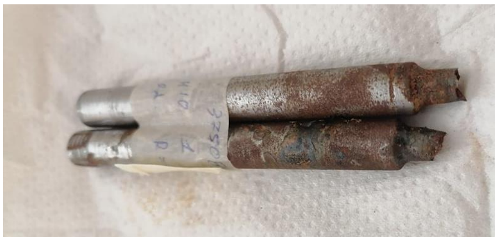
Εικόνα 4.12 (Δοκίμιο 1 μετά τη θραύση που υπέστη σε 37508 κύκλους φόρτισης κάτω από συνθήκες κόπωσης με διάβρωση)
