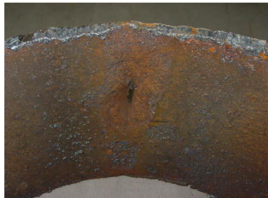
Εικόνα 2.7 (Απεικόνιση τρημματικής διάβρωσης σε υποθαλάσσιο αγωγό)
