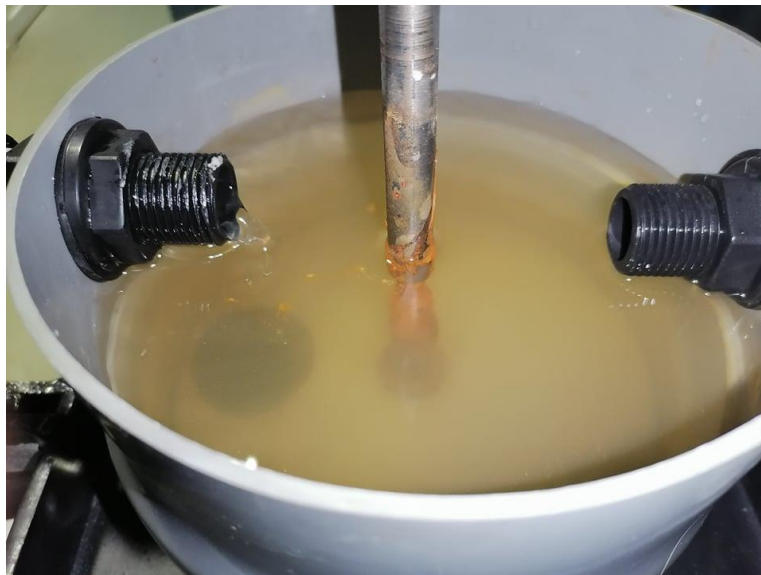
Εικόνα 4.11 (Στιγμιότυπο όπου φαίνεται το δοκίμιο βυθισμένο στο διαβρωτικό διάλυμα με την παρουσία σκουριάς έπειτα από αρκετές ώρες σε συνθήκες κόπωσης)
