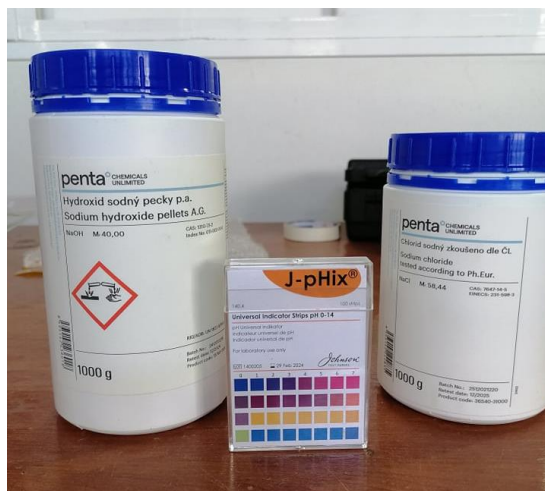
Εικόνα 4.6 (Χαρτάκια μέτρησης του Ph και Χημικά σκευάσματα για τη δημιουργία του διαλύματος διάβρωσης (NaCl & NaOH))
