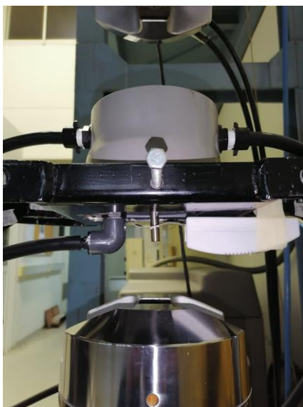
Εικόνα 4.9 (Τοποθέτηση δοκιμίου και αισθητήρα υγρασίας)
