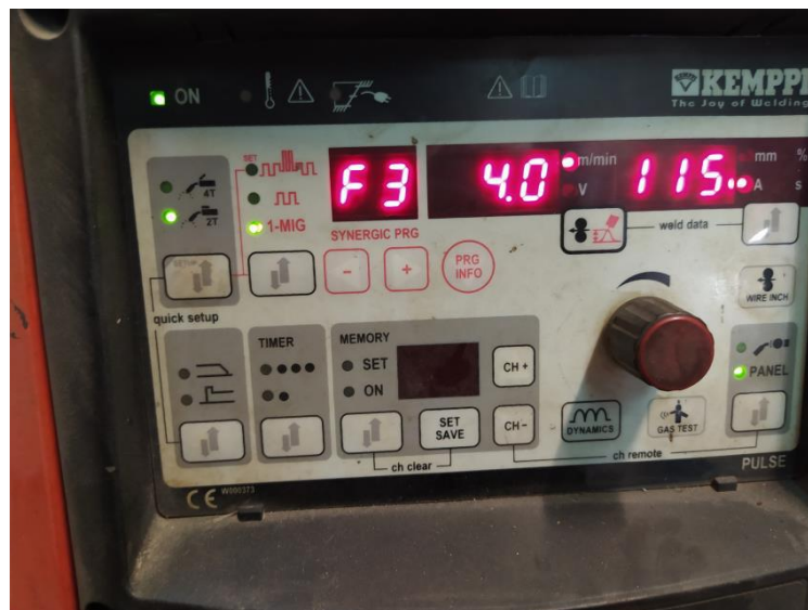
Εικόνα 4.5 (Συνθήκες συγκόλλησης τύπου GMAW [8])
