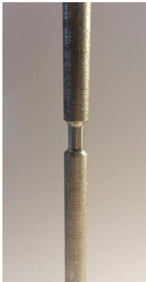
Εικόνα 4.1 (Δοκίμιο αναφοράς χάλυβα St37)
