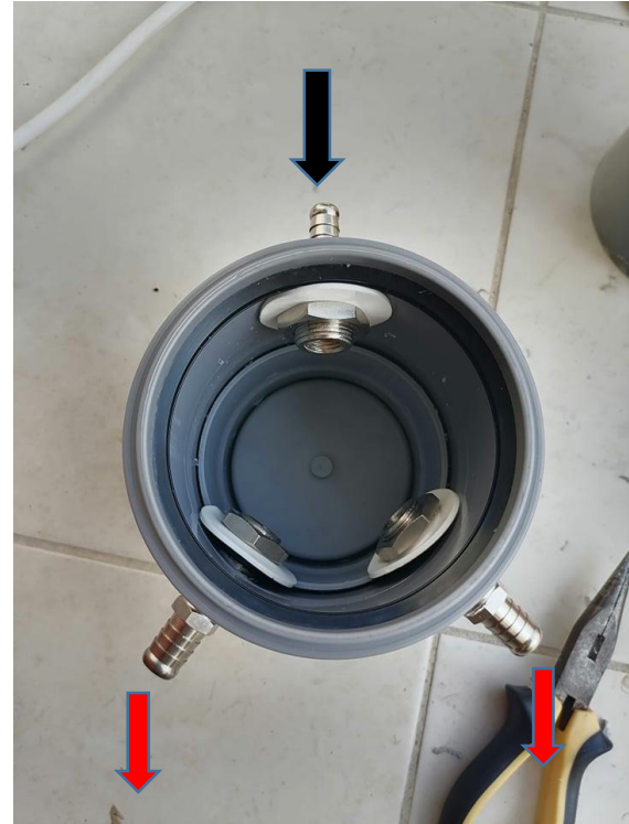
Εικόνα 3.9 (Εσωτερικό κυψέλης με συναρμολογημένες τις παροχές εισόδου (μαύρο βέλος) και εξόδου (κόκκινο βέλος))
