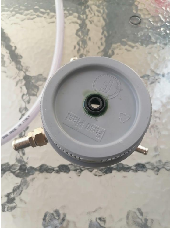
Εικόνα 3.10 (Κάτω μέρος κυψέλης όπου φαίνεται η τοποθετημένη τσιμούχα και περιμετρικά η κόλλα)
