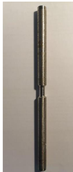
Εικόνα 4.2 (Δοκίμιο χάλυβα St37 με συγκόλληση GMAW)
