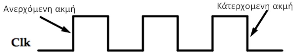
Figure 26 Απεικόνιση ανερχόμενων και κατερχόμενων ακμών σε διάγραμμα χρονισμού.
