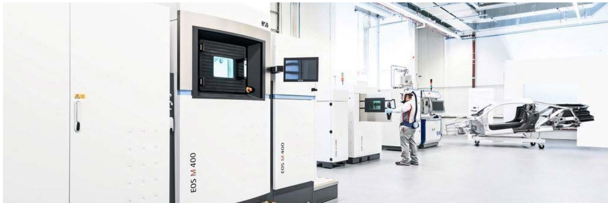
Εικόνα 54 - Μηχανήματα SLM της εταιρίας EOS στο κέντρο προσθετικής παραγωγής της Audi - (73)
