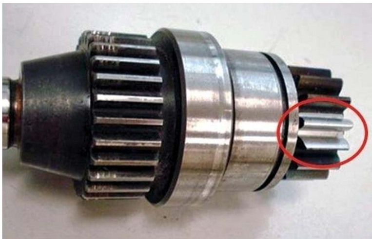
Εικόνα 67 - Επισκευή τμήματος οδόντωσης - (88)
