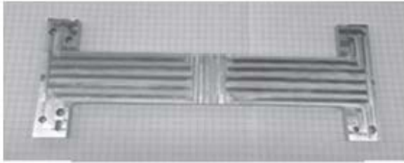
Εικόνα 71 - Δοκός αλουμινίου-Nitinol κατασκευασμένη με τη μέθοδο Ultrasonic Additive Manufacturing - (92)
