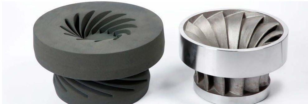
Εικόνα 48 - Καλούπι για πτερωτή αντλίας και το τελικό χυτό εξάρτημα - (59)
