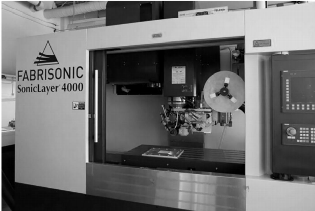
Εικόνα 68 - Μηχάνημα SonicLayer 4000 της εταιρίας Fabrisonic - (90)
