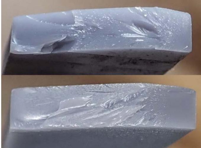
Εικόνα 78 - Επιφάνεια θραύσης δοκιμίου 45 μοιρών (πάνω) και οριζοντίου (κάτω)
