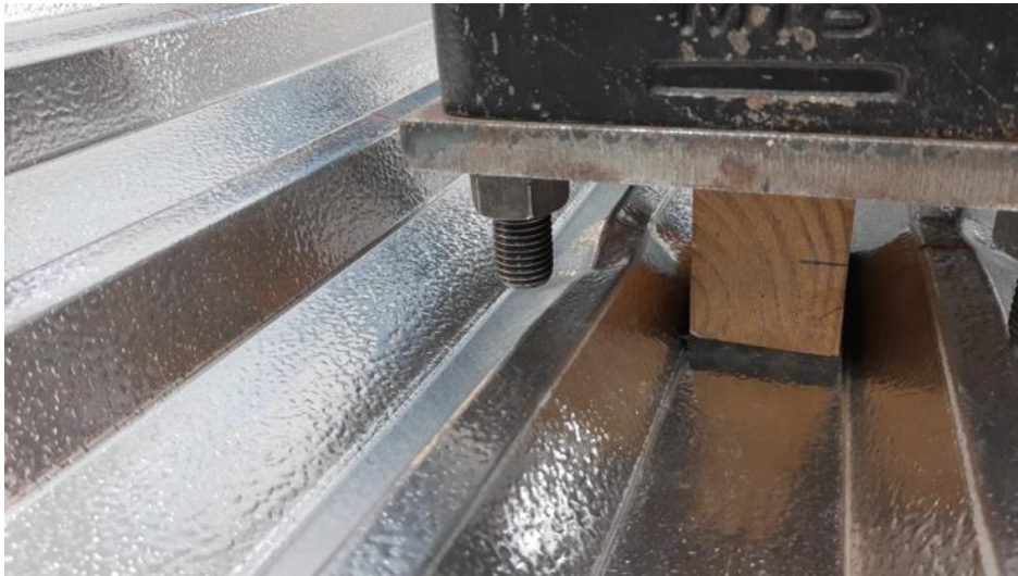
Σχήμα 3.2: Πρώτη εμφανή παραμόρφωση στο φορέα. Εμφάνιση τοπικού λυγισμού στα κεντρικά άνω πέλματα (στιγμιότυπο από το εργαστήριο τεχνολογίας και κατασκευών οπλισμένου σκυροδέματος).
