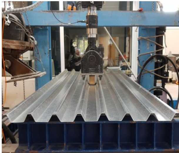
Σχήμα 3.1: Φύλλο αλουμινίου υπό συγκεντρωμένη φόρτιση (στιγμιότυπο από το εργαστήριο τεχνολογίας και κατασκευών οπλισμένου σκυροδέματος).
