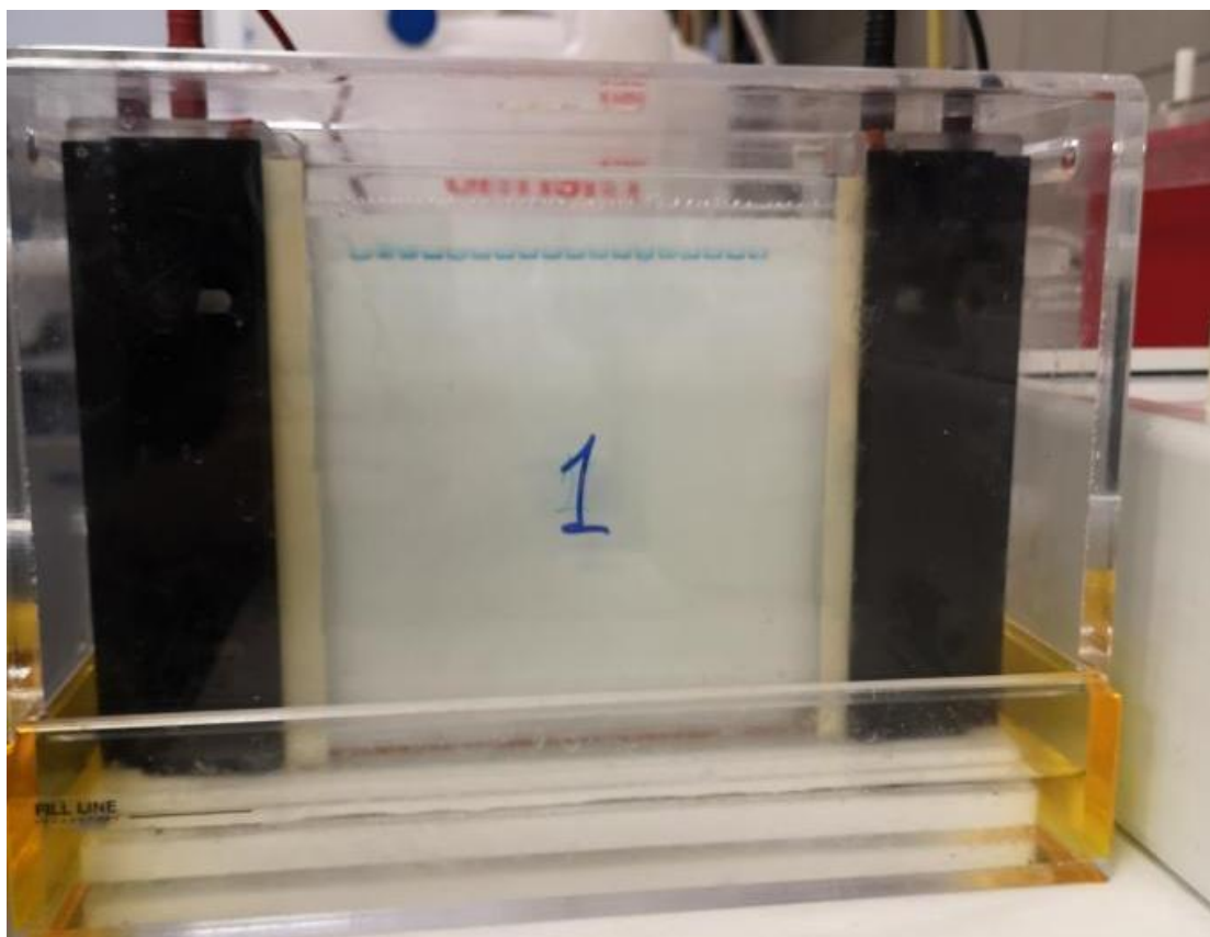
Εικόνα 13: Πηκτή ακρυλαμιδίου σε συσκευή κάθετης ηλεκτροφόρησης με τα δείγματα φορτωμένα στα πηγάδια.
