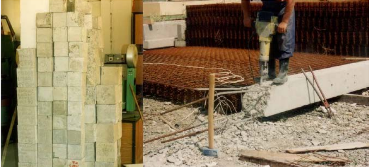
Σχήμα 4.1: Προέλευση ΑΑ, αριστερά κυβικά δοκίμια και δεξιά θραύση υποστυλωμάτων [114]
