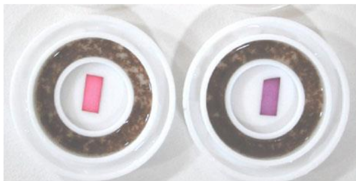
Εικόνα 13. Αρνητικό (αριστερά) και θετικό (δεξιά) αποτέλεσμα για ύπαρξη κυανιούχων σε συσκευή Copway (232).
