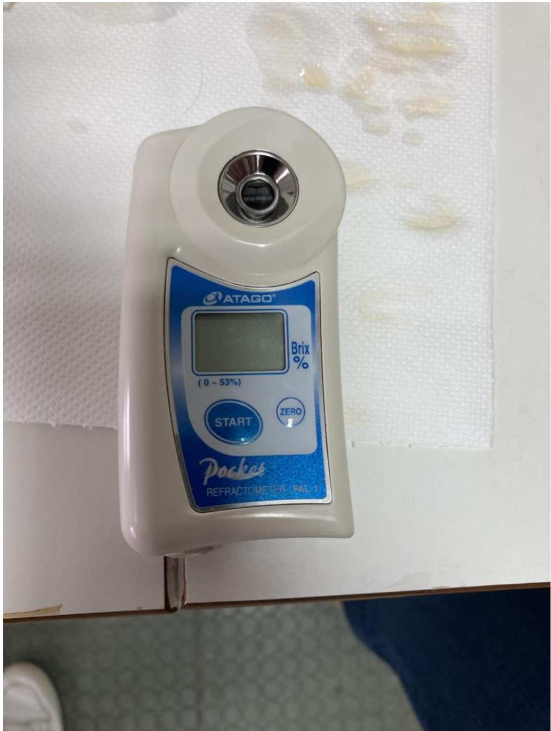
Φωτογραφία 12: Διαθλασίμετρο, μέτρηση διαλυτών στερεών συστατικών χυμού, Εργαστήριο Δενδροκομίας, Βόλος.
