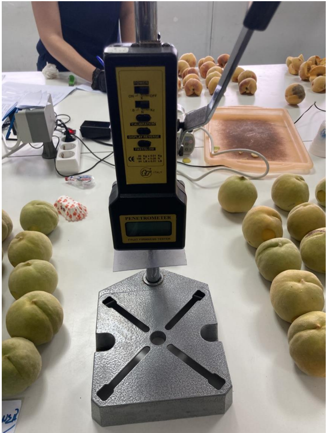
Φωτογραφία 13: Μέτρηση σκληρότητας σάρκας, πενετρόμετρο, Εργαστήριο Δενδροκομίας, Βόλος.
