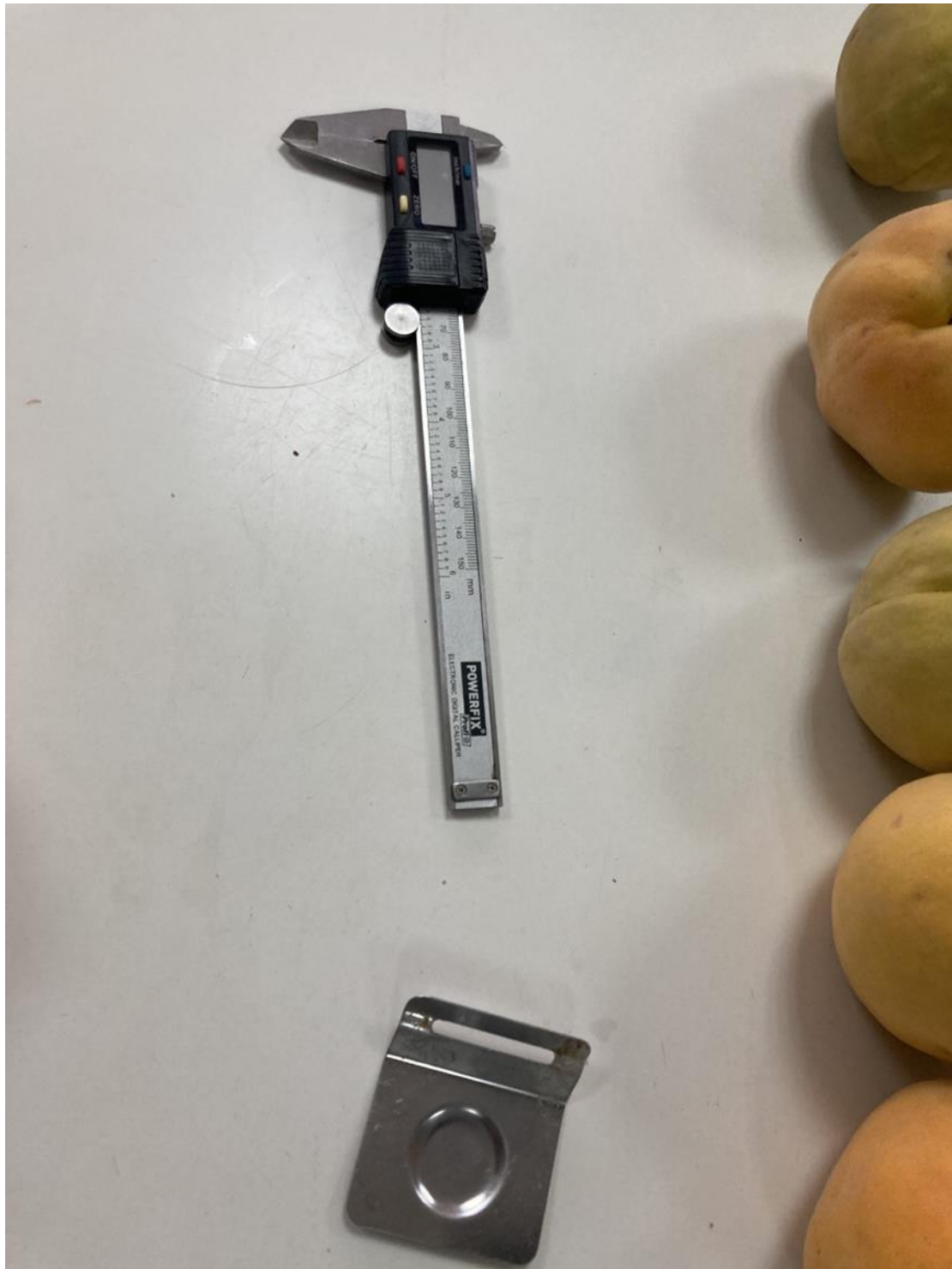
Φωτογραφία 14: Ηλεκτρονικό παχύμετρο, μέτρηση διαμέτρου πυρήνων, Εργαστήριο Δενδροκομίας, Βόλος.
