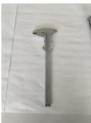
Εικόνα 30: Παχύμετρο Βερνιέρος για μέτρηση διαστάσεων καρπών
