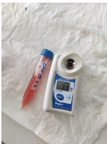
Εικόνα 33: Ρεφρακτόμετρο για μέτρηση Ολικών Διαλυτών Συστατικών
