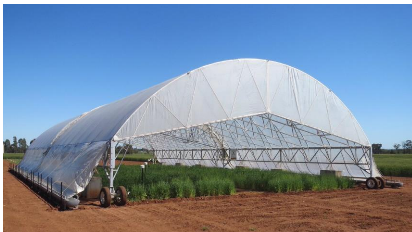
Εικόνα 47: Ένας τυπικός μηχανισμός Rainout Shelter σε καλλιέργεια σιτηρών. Πηγή: https://twitter.com/
