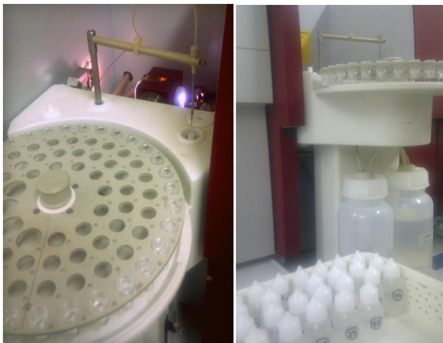
Εικόνα 9: Ατομική απορρόφηση με φούρνο γραφίτη (Graphite Furnace AAS, GFAAS)
