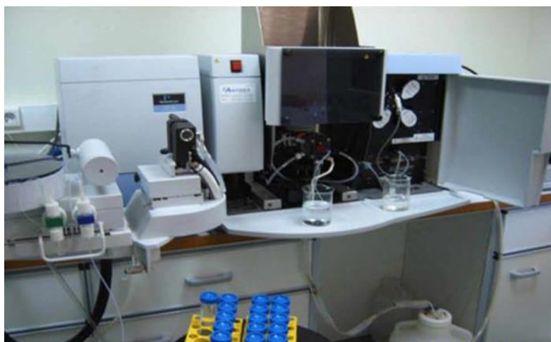
Εικόνα 8: Ατομική απορρόφηση με φλόγα (FAAS).
