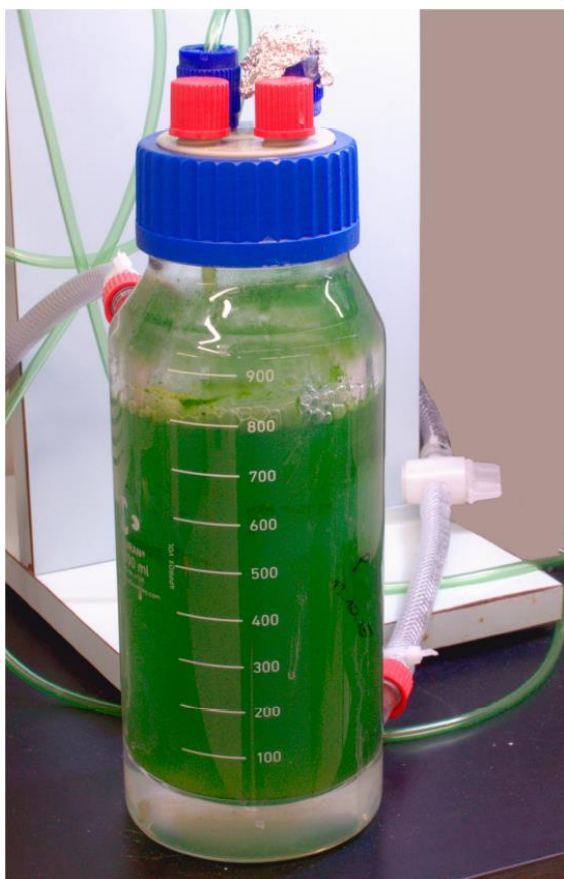
Εικόνα 7: Καλλιέργεια Arthrospira platensis σε βιοαντιδραστήρα τύπου στήλης φουσαλίδων (Kratzer & Murkovic, 2021).
