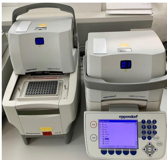
Εικόνα 29: Θερμικός κυκλοποιητής (PCR machine).
