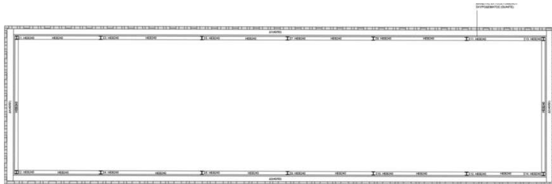
Μεταλλότυπος οροφής ορόφου κλίμακα 1:250
