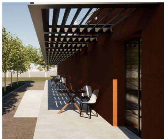
Εικόνα 38 – Τρισδιάστατη απεικόνιση μεταλλικού στεγαστρου προσθήκης
