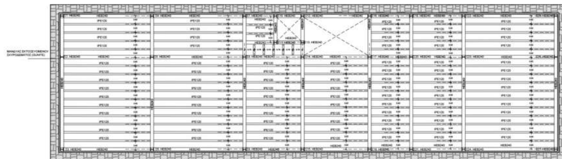
Μεταλλότυπος οροφής Α ορόφου κλίμακα 1:250
