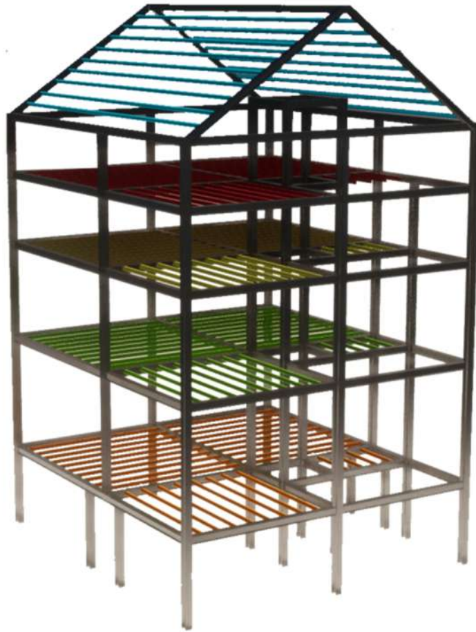
Εικόνα 33 – Τρισδιάστατη απεικόνιση μεταλλότυπου δυτικής πτέρυγας
