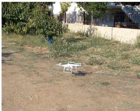
Εικόνα 4.31: Υλοποίηση πτήσης του μη επανδρωμένου αεροσκάφους, τετρακόπτερου Dji Phantom 4 Pro V2.0 (Drone) (Προσωπικό αρχείο).
