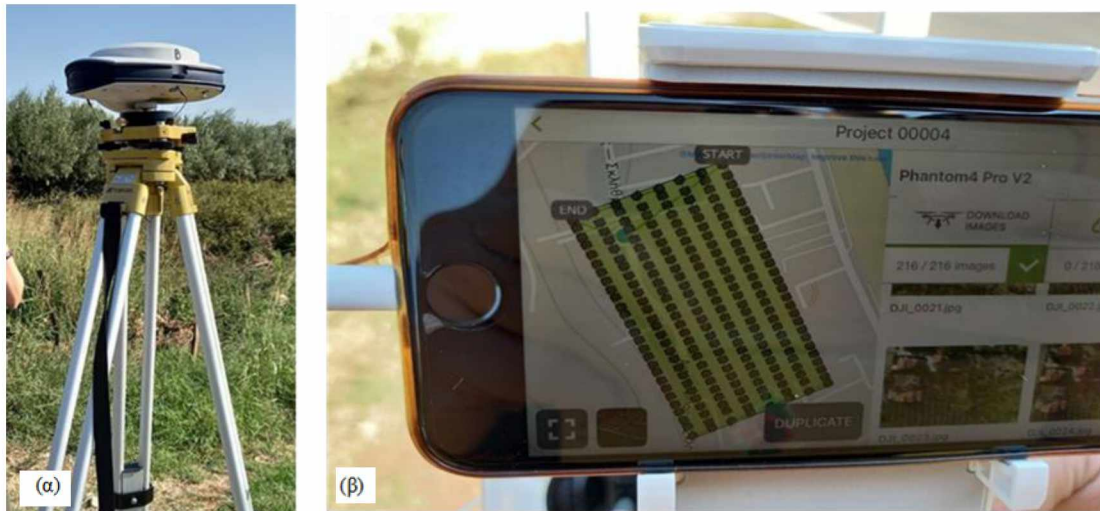
Εικόνα 4.32: (α) Δορυφορικός εντοπισμός ακριβούς θέσης σημείων ελέγχου στο έδαφος, (β) Λήψεις που προέκυψαν από την πτήση του μη επανδρωμένου αεροσκάφους, τετρακόπτερου Dji Phantom 4 Pro V2.0 (Drone) (Προσωπικό αρχείο).
