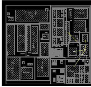
Εικόνα 5: Floorplan ενός ολοκληρωμένου κυκλώματος
