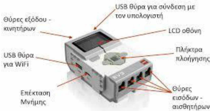
Εικόνα 15: Τα τμήματα του Brick EV3 (Τουβλάκι EV3)
