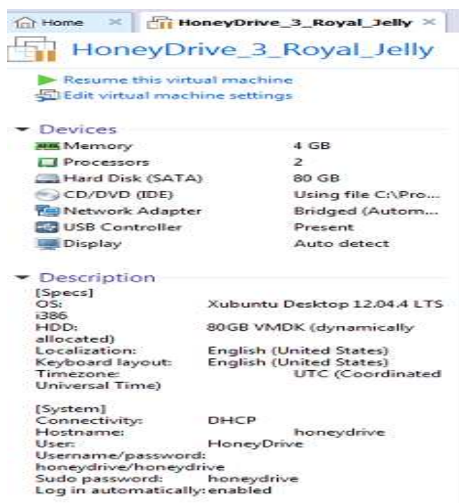
Εικόνα 10.1 : Χαρακτηριστικά του Virtual Machine που φιλοξενεί το HoneyDrive.
