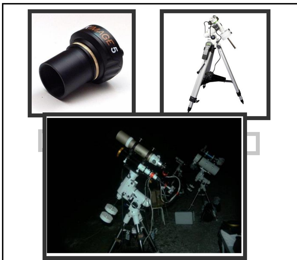
Εικόνα 30: Πάνω: Αριστερά μια τυπική κάμερα CCD για τηλεσκόπιο, δεξιά στήριξη διάταξης τηλεσκοπίου με οδηγητή (mount). Κάτω: Εξοπλισμοί σε φωτογραφική διάταξη, μπροστά ισημερινή στήριξη με δύο διοπτρικά τηλεσκόπια (ένα για
