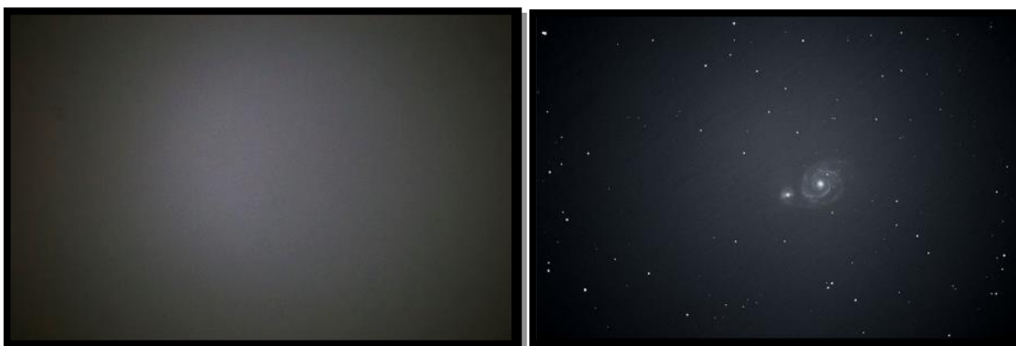
Εικόνα 32: Αριστερά, στο flatframe φαίνεται η κατανομή της φωτεινής πληροφορίας στον αισθητήρα. Δεξιά, στο Lightframe παρατηρείτε ο στόχος. Η ανομοιομορφία στην κατανομή του φωτός οφείλεται στο ότι το καρέ flat δεν έχει εφαρμοστεί.
