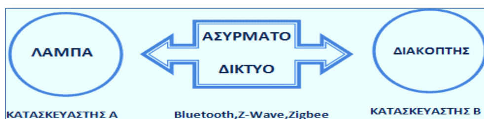
Εικόνα 9: Παράδειγμα μοντέλου επικοινωνίας Device-to-Device
