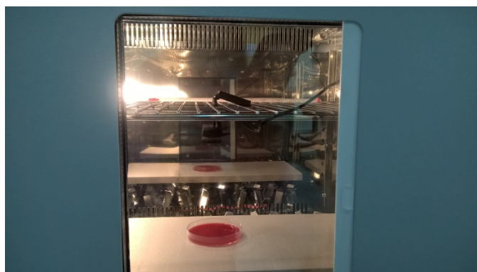
Εικόνα 8. Πειραματική διάταξη στο εσωτερικό του κλιβάνου (φωτεινή πηγή, εμβολιασμένο αιματούχο τρυβλίο (cos), κάμερα).
