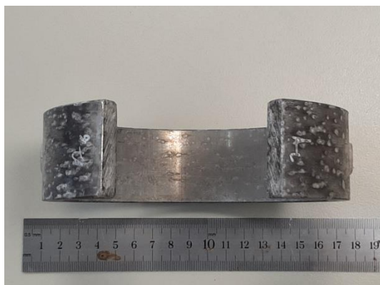
Εικόνα 83: Δοκίμιο A6 Εσωτερική επιφάνεια
