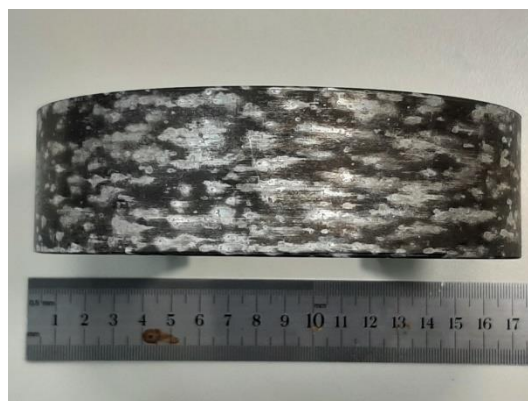
Εικόνα 64: Δοκίμιο A1 Εξωτερική επιφάνεια
