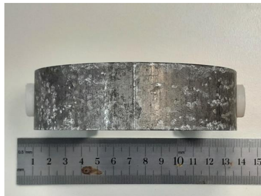
Εικόνα 96: Δοκίμο Β3 Εξωτερική επιφάνεια
