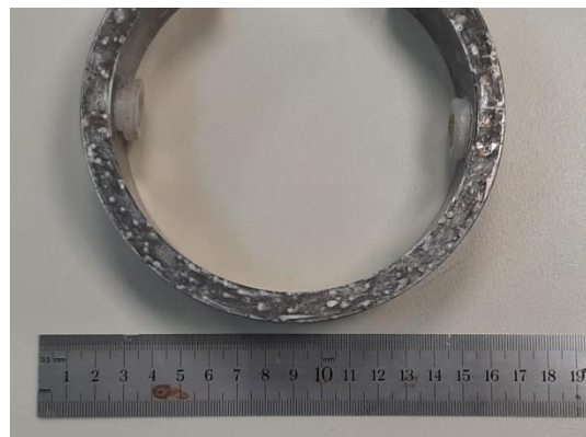
Εικόνα 82: Δοκίμιο A5 Κάτω επιφάνεια
