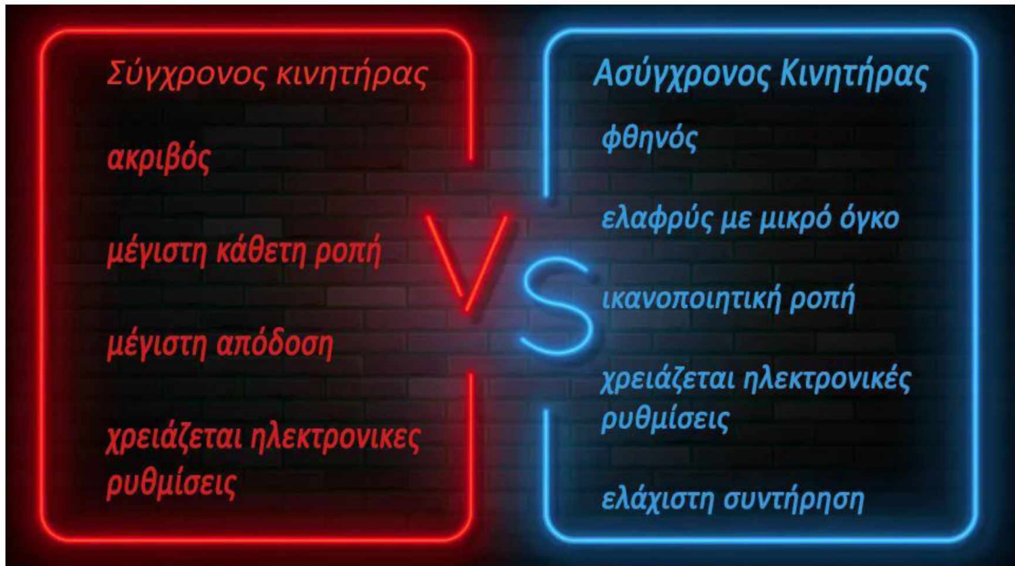
Σύγκριση σύγχρονου και ασύγχρονοι κινητήρα
