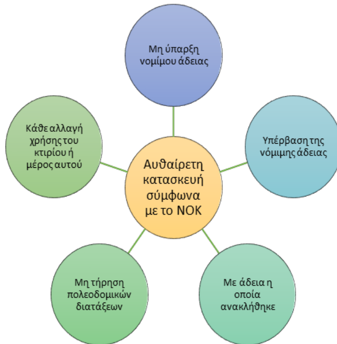
Σχήμα 6: Αυθαίρετη κατασκευή σύμφωνα με το ΝΟΚ (Ιδία Επεξεργασία)
