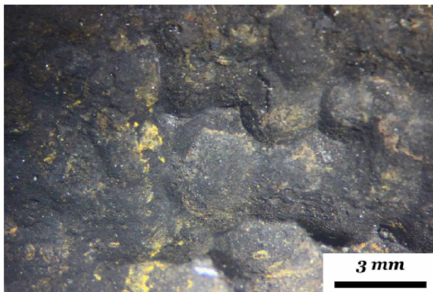
Σχήμα 4.5: Εστιασμένη εικόνα στο σημείο της μεταλλικής κωνιοποίησης
