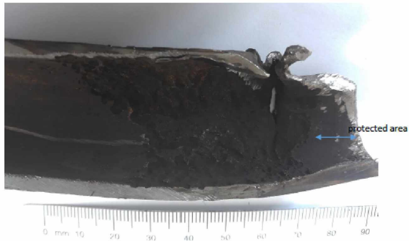
Σχήμα 4.8: Εσωτερική επιφάνεια του σωλήνα, υποδεικνύεται το τμήμα του αυλού που προστατεύεται από το σωλήνα κράματος Ni-Cr
