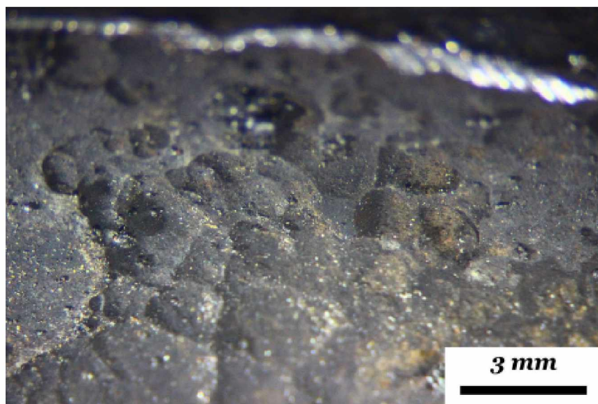
Σχήμα 4.6: Εστιασμένη εικόνα στο σημείο της μεταλλικής κονιοποίησης
