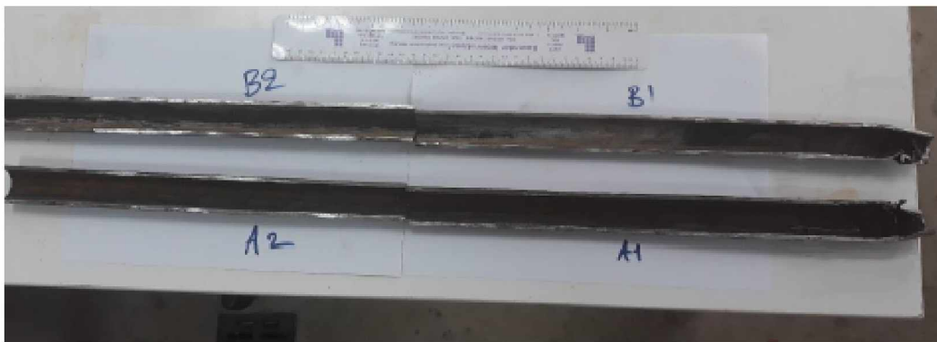
Σχήμα 4.2: Εσωτερική επιφάνει του σωλήνα μετά την κοπή στα τμήματα A1, A2, B1, B2
