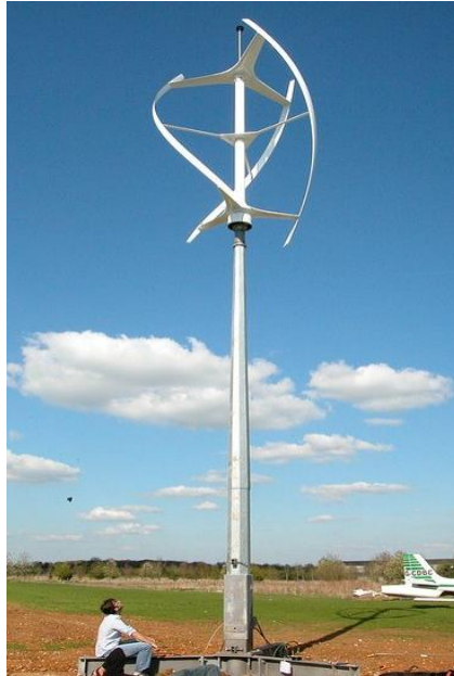
Εικόνα 8: ΑΚΑ τύπου Darrieus σταθερών πτερυγίων σχήματος πλεξούδας [8]
