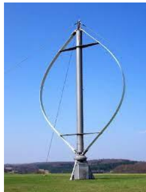
Εικόνα 6: ΑΚΑ τύπου Darrieus σταθερών πτερυγίων σχήματος αυγού [8]
