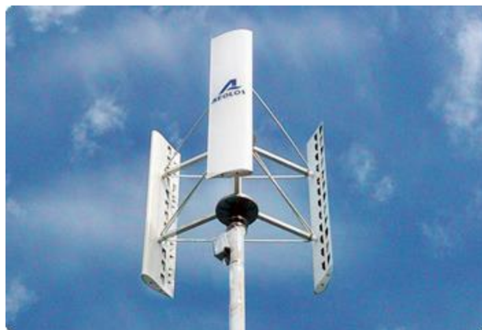
Εικόνα 7: ΑΚΑ τύπου Darrieus διευθυνόμενων πτερυγίων [8]
