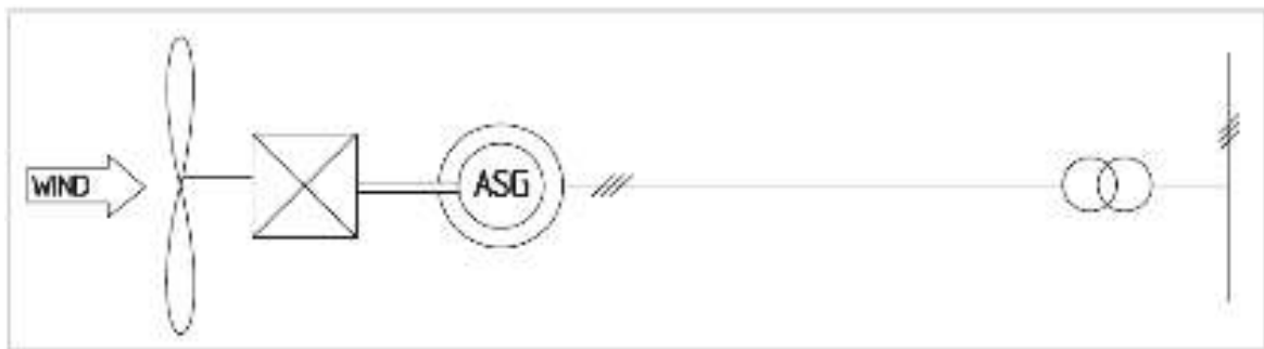
Σχήμα 6.4: Διάταξη ανεμογεννήτριας σταθερής ταχύτητας με ασύγχρονη μηχανή (διπλωματική εργασία, Κατσαρός Νικόλαος, 2019)
