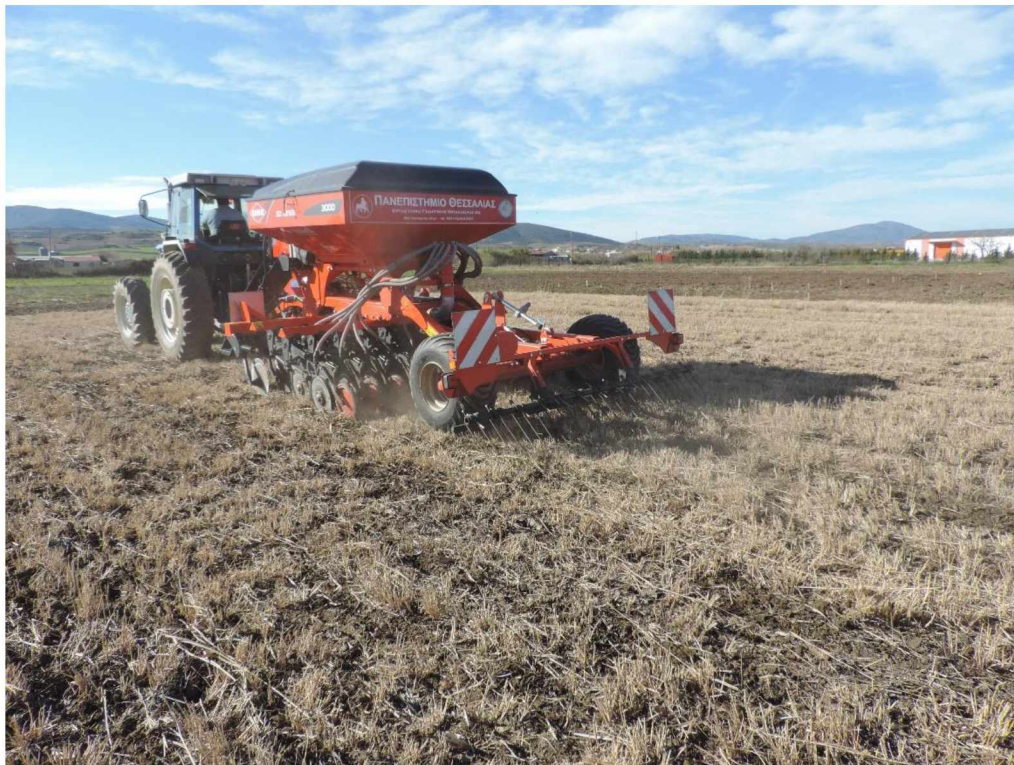
Εικόνα 3: Εγκατάσταση ψυχανθών με σπαρτική μηχανή ακαλλιέργειας σε εγκατεστημένη φυτεία switchgrass στο Βελεστίνο.
