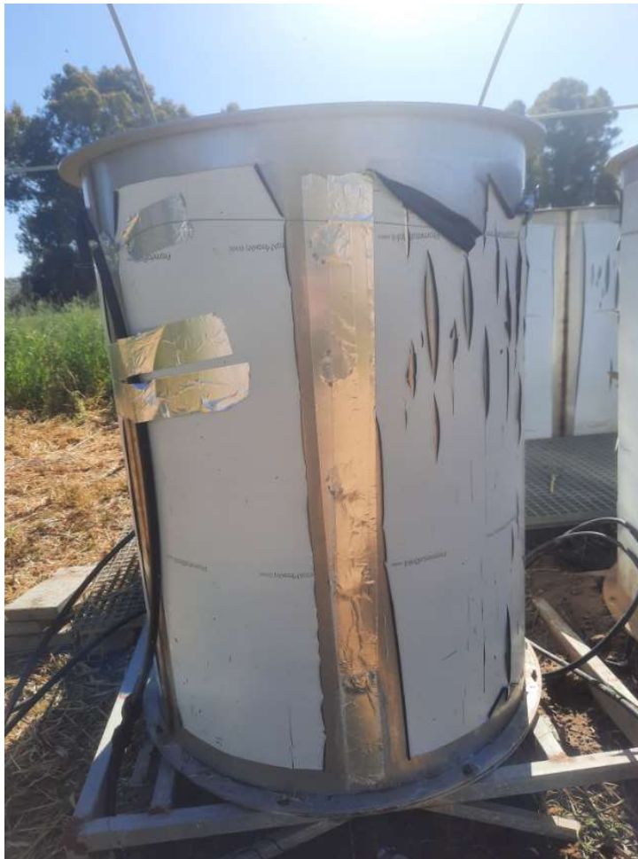
Εικόνα 1: Λυσίμετρο με ύψος 1,25 m και όγκο 0,867 m 3 στις εγκαταστάσεις του Ινστιτούτου Γεωργικών Ερευνών.
