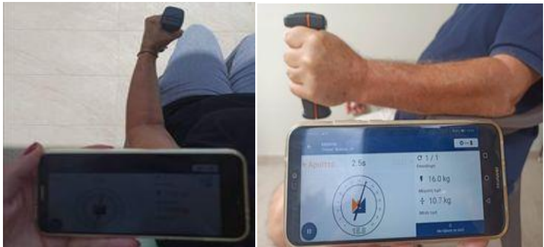
Έικόνα 2: Μέτρηση Δύναμης χειρός με δυναμόμετρο χειρός (grip-KFORCE by KINVENT) και την αντίστοιχη εφαρμογή της εταιρίας.
