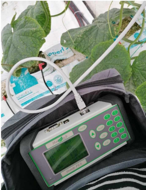
Εικόνα 4: Φθορισμόμετρο συνεχούς διέγερσης Handy-PEA
