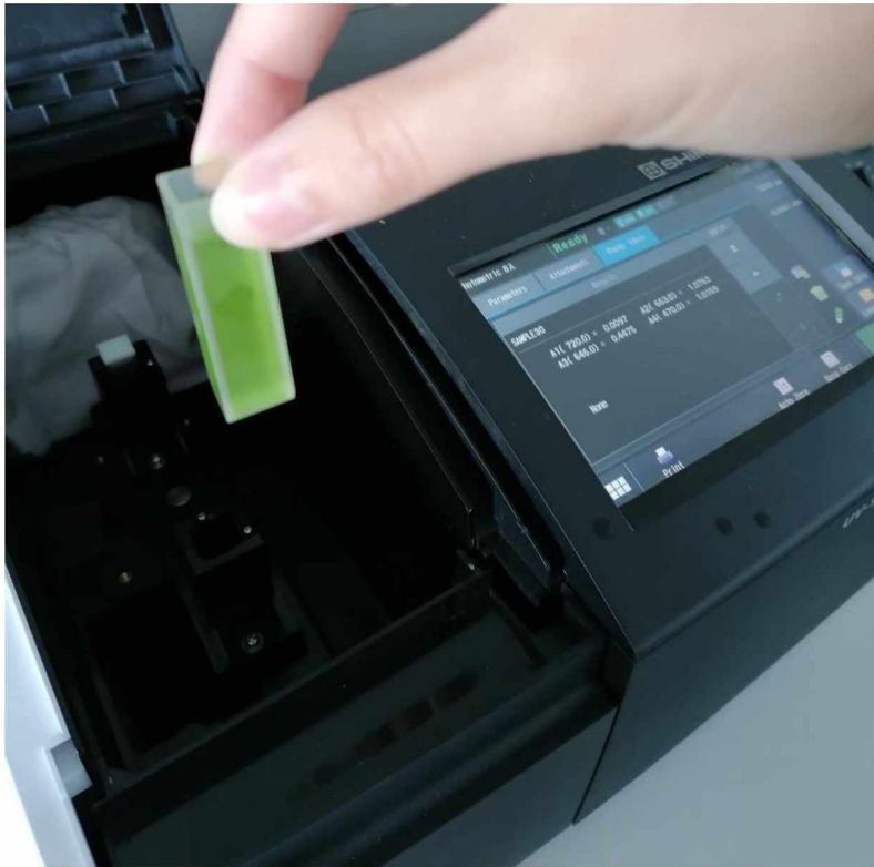
Εικόνα 9: Φασματοφωτόμετρο UV900 και δείγμα με εκχύλισμα μέσα σε κυβελίδα.
