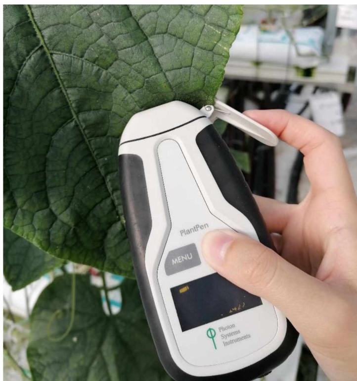
Εικόνα 6: Μέτρηση PRI με το FluorPen FP 110/S
