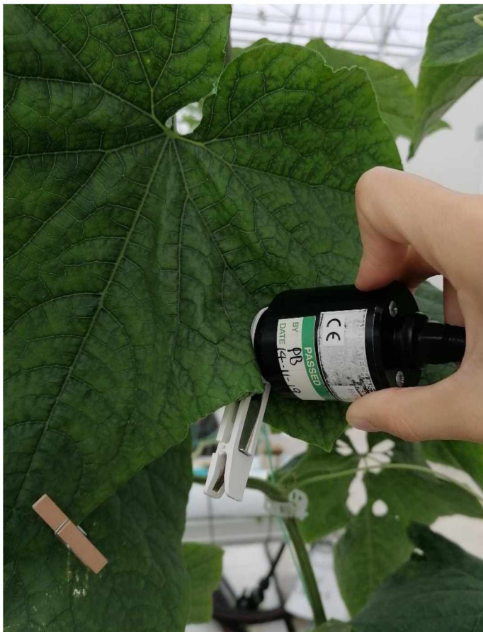
Εικόνα 5: Κεφαλή Φθορισμόμετρου Handy-PEA με λαμπτήρες LED
