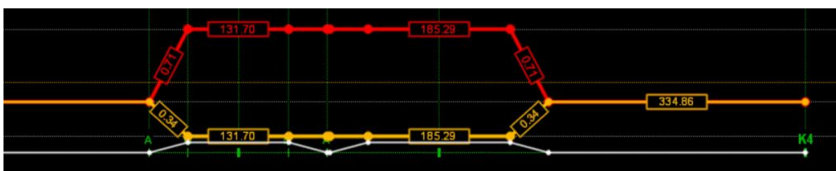
Εικόνα 9. Διάγραμμα επικλίσεων για ομόρροπες καμπύλες με απόσταση μικρότερη των 10 μ.
