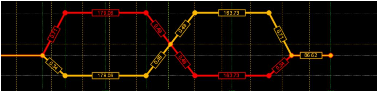
Εικόνα 10. Διάγραμμα επικλίσεων για αντίρροπες καμπύλες με απόσταση μικρότερη των 10 μ.
