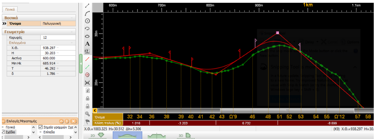
Εικόνα 45. Διόρθωση κλίσης και ακτίνας
