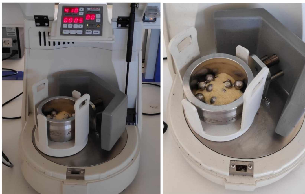
Εικόνα 15,16. Άλεση δείγματος σε σφαιρόμυλο Planetary Mono Mill PULVERISETTE 6 classic line, FRITSCH GmbH.
